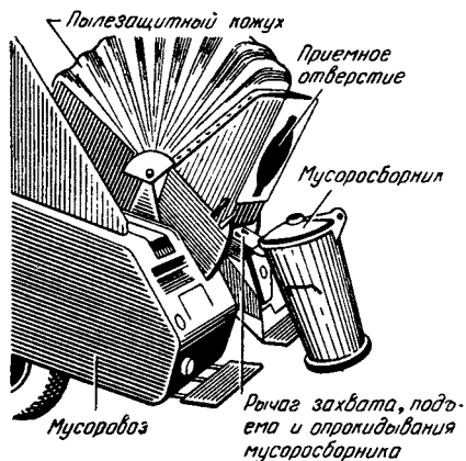
Рис. 201. Устройство для механизированной и беспыльной загрузки мусоровоза
