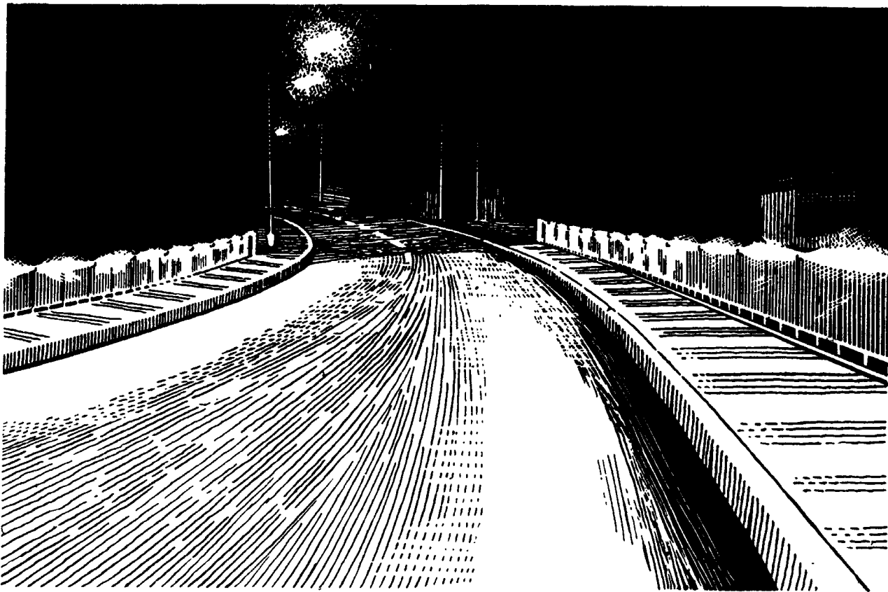
Рис. 186. Освещение городского моста парапетными светильниками (Рим)
